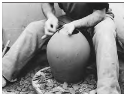
Figura 36. La bréga liscia è usata per sgrassare lo spessore della parete. L'argilla, asportata a scaglie, è chiamata sgarzatura .
