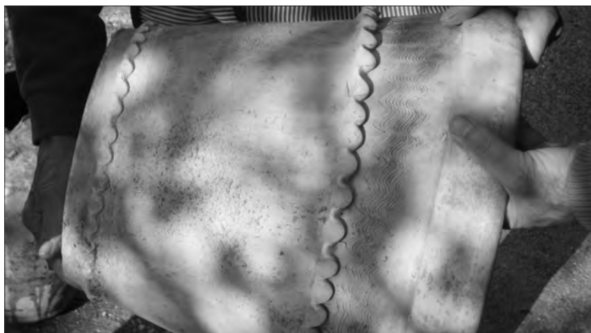
Figura 82. Una trocca di Duilio Bartocetti, munita di due cordoli di rinforzo e di un robusto orlo superiore, raddoppiato nello spessore.
