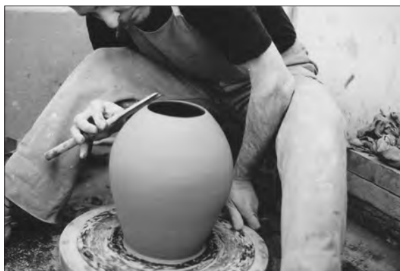
Figura 26. Rifinitura del composto : il braccio destro è tenuto sotto il ginocchio mentre il tornio è spinto a mano sinistra.
