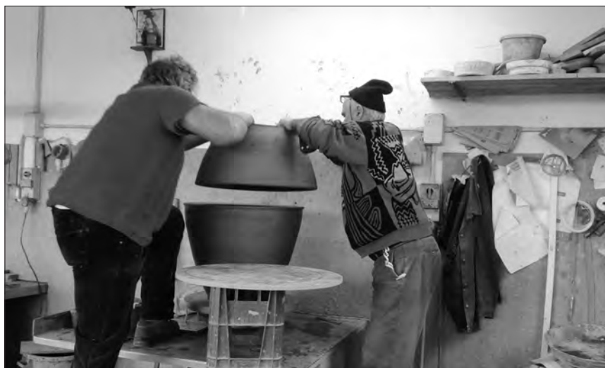
Figura 30. Deruta: col servizio di un aiutante il vasaio colloca il cappellaccio sul fusto dell'orcio .
