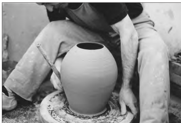
Figura 27. Nella rifinitura della parte inferiore del composto la canna è impugnata, come in questo caso, sulla punta.
