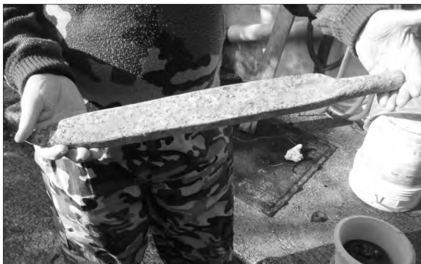
Figura 10. La battóra , usata dagli orciai per battere l'argilla sul banco .
