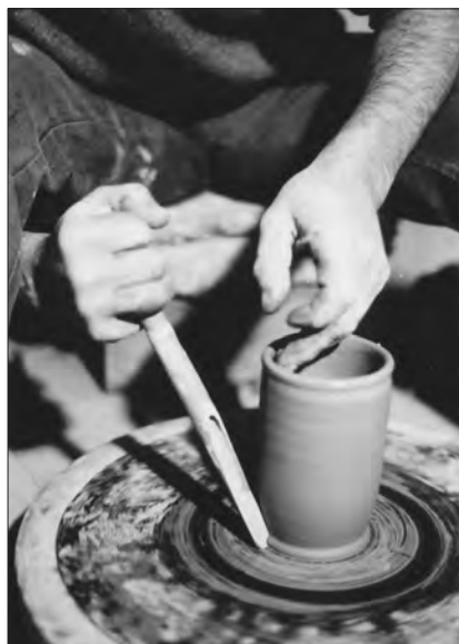
Figura 37. La bréga per incidere il piede a disco dei manufatti, in questo caso la campanella del bollitore per le botti.
