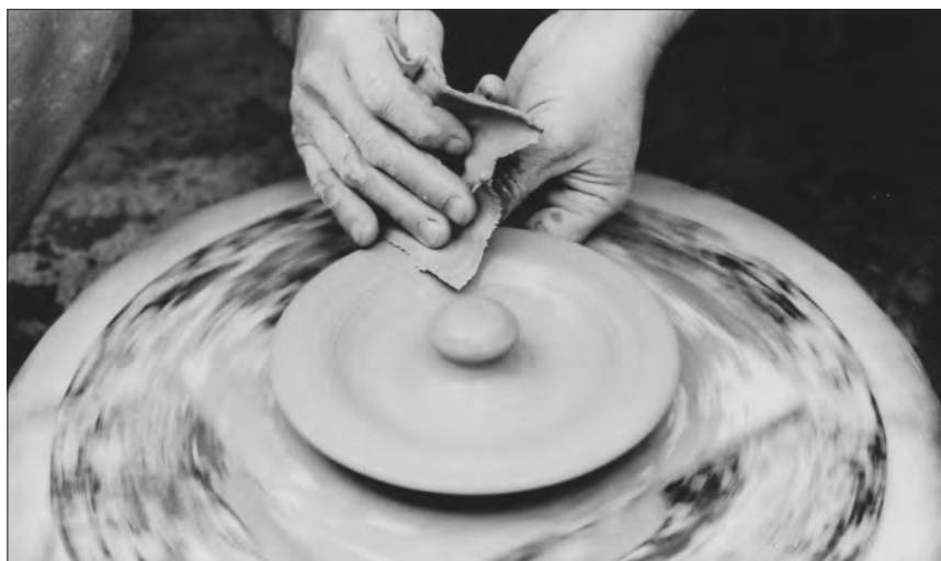
Figura 31. L'orciaio usa la pèzza per inumidire e contemporaneamente modellare e levigare il manufatto: in questo caso un coperchio con pomello a presa centrale.
