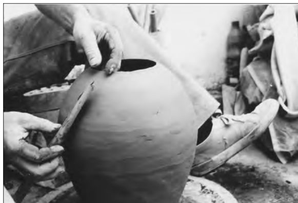
Figura 24. L'azione del piede, usato energicamente sullo spessore del disco, conferisce continuità al movimento rotatorio.
