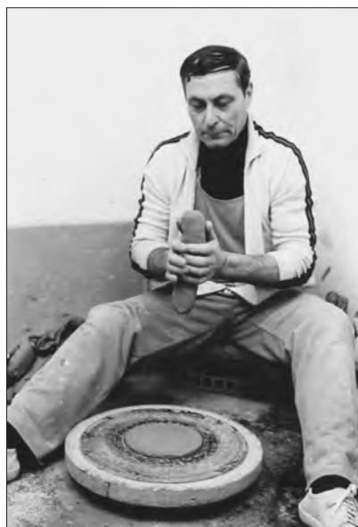
Figura 12. Modellazione a colombino: la preparazione del bigolo .
