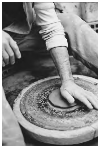
Figura 13. La preparazione del fondo, appiattendo sul tornio un cordolo di argilla.
