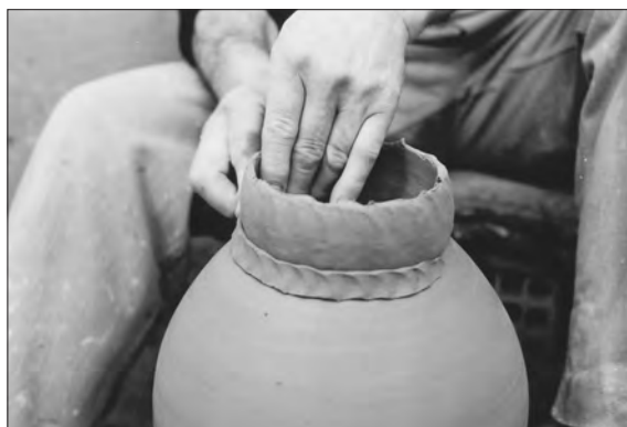
Figura 50. Modellazione del 'collo' di un orcio.
