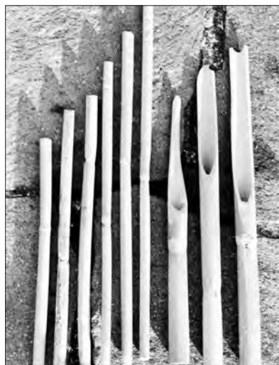
Figura 33. Le stécche (a sn) e le bréghe di canna (da sn a ds quella liscia, quella con lo 'scavo' e coi 'denti'). Si notino gli intagli a caldo sulle stécche da una, due e tre righe.
