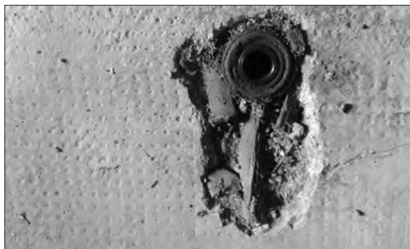
Figura 19. Il cuscinetto a sfera in cui è inserito il perno rotante del tornio.
