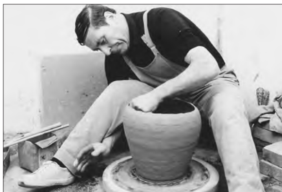
Figura 28. Il tornio di tipo primitivo impone una scomoda postura di lavoro ma supporta egregiamente la modellazione a colombino, mai abbandonata dagli orciai.
