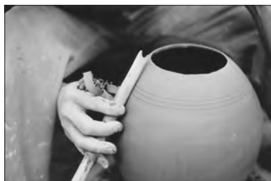
Figura 35. I diversi modi di impugnare la bréga più tagliente
