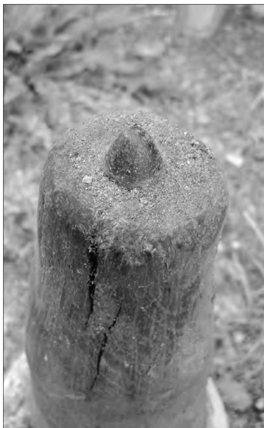
Figura 21. Opportunamente oliato, il puntale in ferro del perno fisso migliora le non eccellenti prestazioni cinetiche dello strumento.
