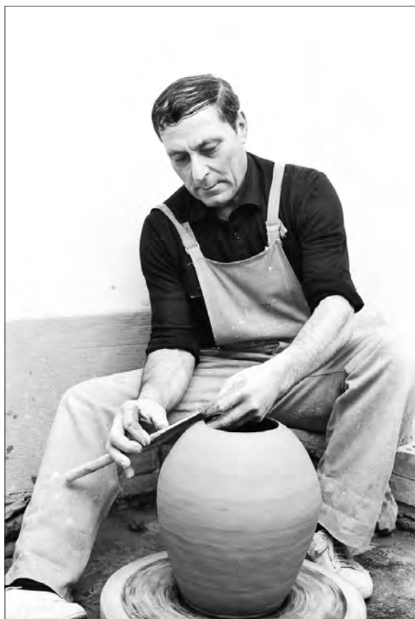
Figura 25. La rifinitura del composto è operazione laboriosa: in questo caso il tornio è spinto col piede sinistro mentre la canna è impugnata con entrambe le mani.
