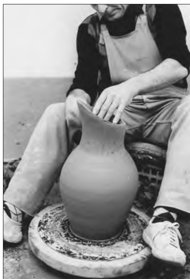
Figura 51. Orcio, modellazione della bocca.
