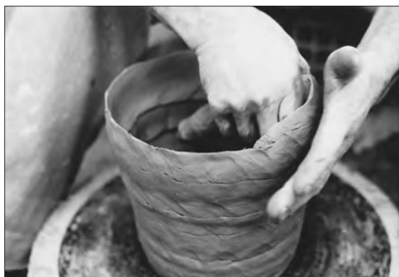
Figura 15. La sovrapposizione in sequenza dei bigoli , nella progressiva costruzione della parete.
