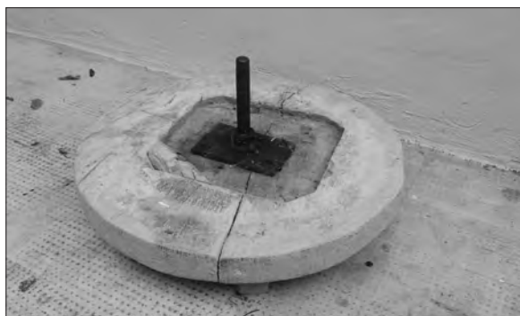
Figura 18. Il tornio di Giuseppe Furiassi è a perno rotante e utilizza per ralla un cuscinetto a sfera inserito nel pavimento (Figura 19).
