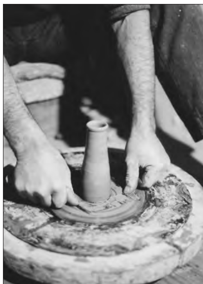
Figura 38. A modellazione ultimata, per staccare il manufatto dal tornio l'orciaio striscia sul disco il fil di ferro.
