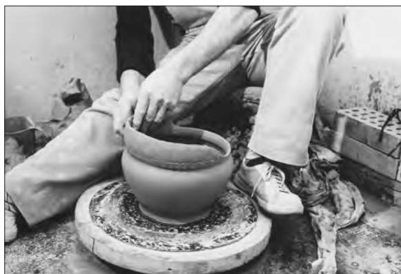
Figura 23. L'orciao muove il tornio col piede sinistro, calibrandone i movimenti in entrambi i sensi di rotazione; le mani restano impegnate nella modellazione.
