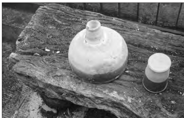
Figura 75. Il bollitore per botti, nella sua classica forma ad imbuto.
