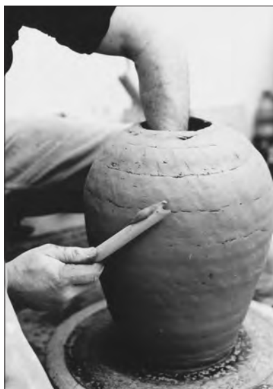
Figura 42. La prima rifinitura della parete è effettuata con la canna più tagliente, usata sul fianco.
