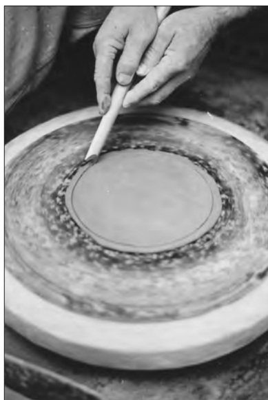
Figura 14. La rotazione del tornio garantisce la perfetta circolarità dell'incisione, eseguita tenendo ben salda la 'spatola' di canna.
