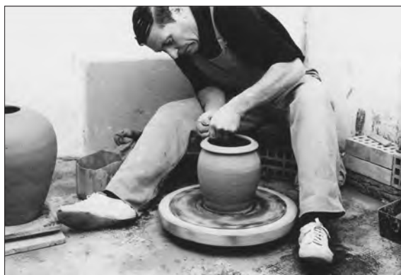
Figura 59. L'orciaio 'rovescia' il bordo superiore del machiardlin .
