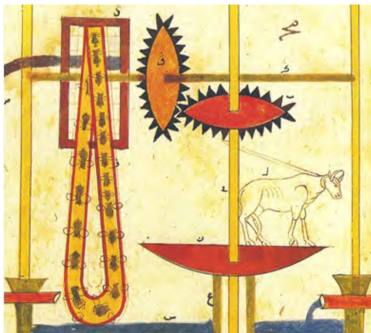
Fig. 6 - Rappresentazione del nastro di Möbius nel manoscritto arabo di al Jazari del 1216 contenente la descrizione di un automa-giocatolo idraulico. Si può osservare la perfetta corrispondenza tra la visione prospettica delle cinghie che trascinano i contenitori d'acqua con la fotografia in Fig. 2b.
