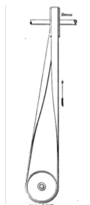
Fig. 5 - Una configurazione a nastro di Möbius fa diventare più stabile la trasmissione del movimento tra pulegge a 90°. Rappresentazione tratta dalla rivista American Machinist del 1903 (6) .
